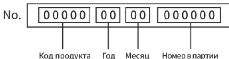
Дата изготовления изделия зашифрована в серийном номере, напечатанном на корпусе инструмента. Первые 2 цифры обозначают год выпуска, следующие 2 цифры – месяц.
